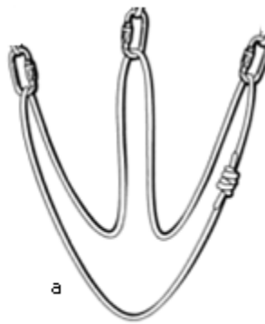
Dinamik bir ana emniyet noktası a) Perlon bant halkası karabinalardan geçirilir b) Aradaki bölümlere lup atılarak birleştirilir
