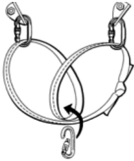
Dinamik bir ana emniyet. Perlonun arada kalan bölümüne lup yapılarak noktalardan birinin çıkması durumunda karabinanın takılı kalması sağlanır.
